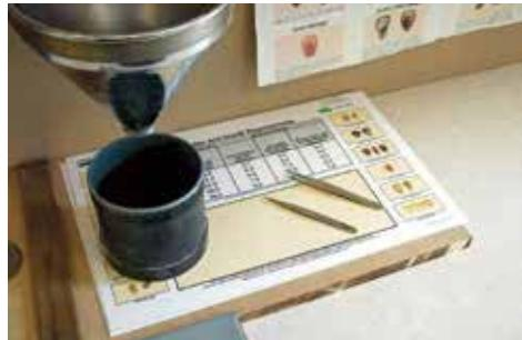
玉米檢測工作臺，用以檢測玉米外觀是否破損及
