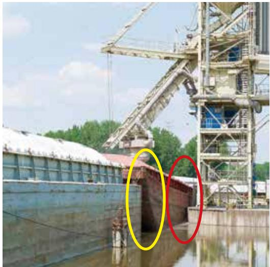
駁船正在裝填玉米情形，紅圈處因已裝填玉米，船身吃水較深，黃圈處尚未裝填，因此吃水較淺。
