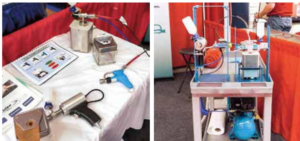
移動式注射器可攜帶右上角空氣壓縮罐進行注射 固定式注射器可利用下方空壓機進行大量注射，主要用於仔豬
