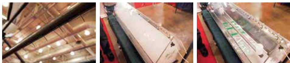
管線下方具兩排金屬針，透過電流以尖端放電方式釋放靜電 模擬粉塵時之狀態，密閉盒內噴入煙霧 啟動靜電吸附空氣中微粒，粒子掉落地板，過程約 3-5 秒。
